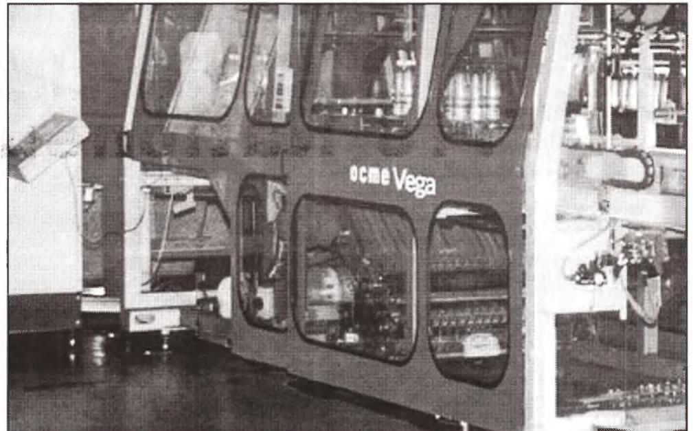
Ein OCME Vega Schrumpftunnel sorgt für die richtige Verpackung.
